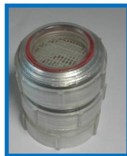
Suporte dos filtros
